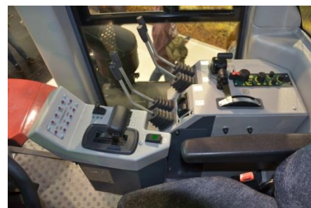
Компоновка органов управления на тракторе с новой кабиной
