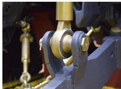
**Новый тяговый брус.** Теперь можно заказать в качестве опции новый ТЯГОВЫЙ БРУС для работы с тяжелыми прицепными агрегатами. Новое тягово-сцепное устройство выдерживает вертикальную статическую нагрузку 4080 кг, диаметр пальца сцепки 50,8 мм.
