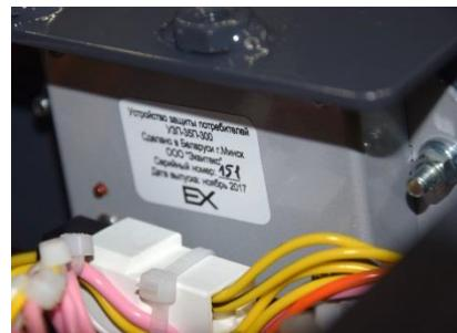
**Электрооборудование.** В целях исключения пиковых напряжений в состав трактора введен ограничитель напряжения. Для подключения внешнего оборудования на задних крыльях трактора выведены две розетки на 12 и 24 В.
