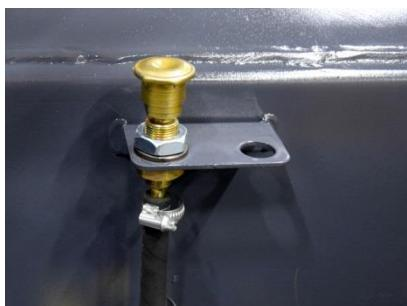
**Упрощено обслуживание заднего моста.** Для лучшей защиты от грязи и удобного контроля и обслуживания сапун заднего моста перенесен выше и расположен за топливным баком.
