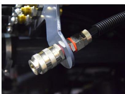
**Накачать колеса или продуть фильтроэлементы в поле** теперь будет просто. В пневмосистеме трактора установлен дополнительный порт подключения, а комплектация трактора дополнена набором устройств для подкачки и продувки.
