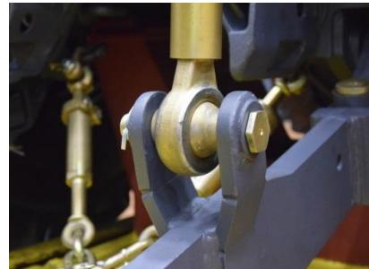
**Новый тяговый брус.** Теперь можно заказать в качестве опции новый ТЯГОВЫЙ БРУС для работы с тяжелыми прицепными агрегатами. Новое тягово-цепное устройство выдерживает вертикальную статическую нагрузку 4080 кг, диаметр пальца сцепки 50,8 мм.
