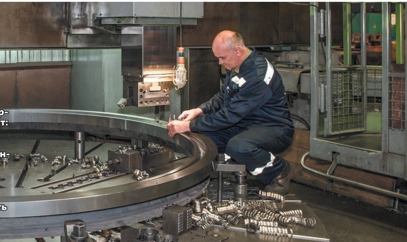
● Токарь-карусельщик Александр Шабанов за изготовлением важной детали для внутреннего корпуса ЦНД главного турбогенератора атомного ледокола «Якутия»
