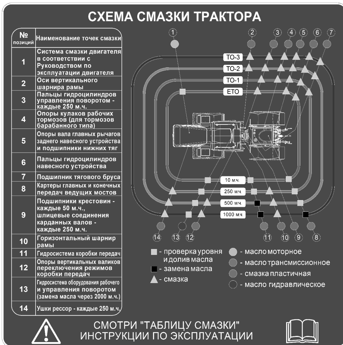
Рисунок 68 – Схема смазки трактора
